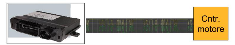
Dopo avere selezionato la posizione di avviamento (avviamento "Soft") il motorino di avviamento viene attivato fino a quando il motore non entra in funzione ovvero...
